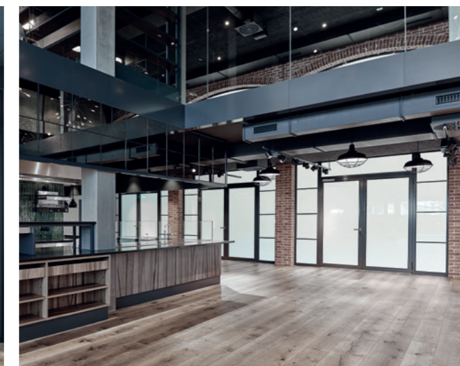
Eventverglasung mit schaltbarem Glas
